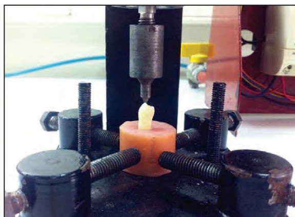
Figura 5. Cargas axiales puntuales sobre la cúspide de soporte de un premolar inferior.
