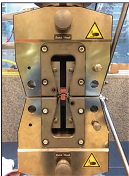
Figura 2. Muestra posicionada en máquina para ensayo de tracción Zwick/Roel® Z100.
